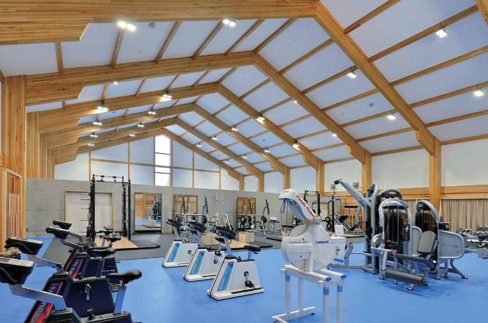
トレーニングセンターのウェイトトレーニングルームの照明 切妻屋根の天井構造材に均等配置で設置されたLED角形高天井器具
