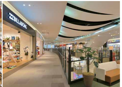
2灯1組のLEDユニバーサルダウンライトを採用した3階共用通路
