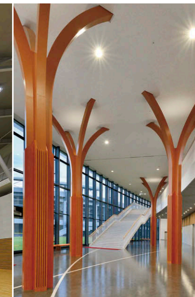
エントランスホール 木に模してデザイン化し、その木に仕込んだ照明で天井面を照射
