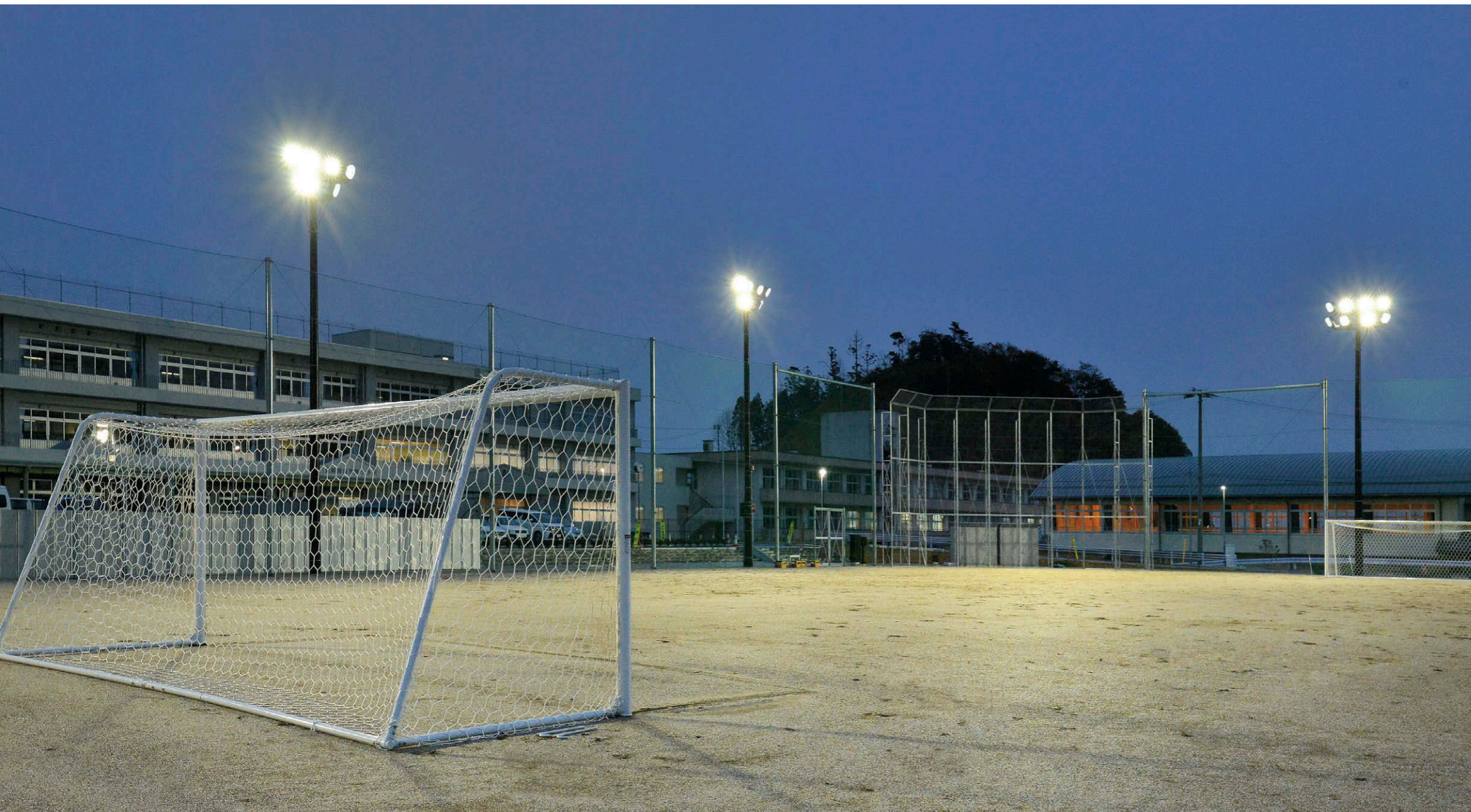
グラウンドの照明(サッカーゾーン) 利用者の目線から見た光環境。様々な方向から届くLED投光器①の光が混ざり合い、均一な明るさを実現
