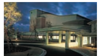
ライトアップ：35W CDM-Rスポットライト2台用と1台用で外壁を照射
