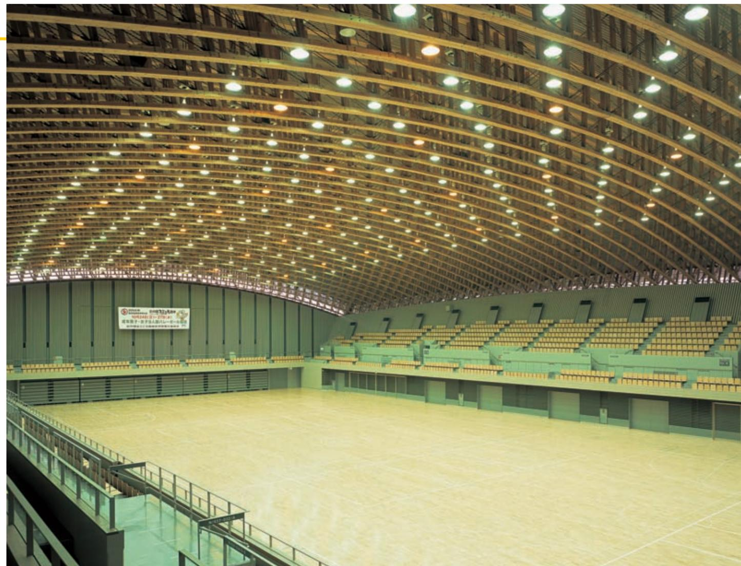
2階コーナーからメインアリーナを望む：天井全体に高天井用反射笠器具(広照形)をパイプ吊りで設置。空間を一様に照明し、空間照度を高めている
