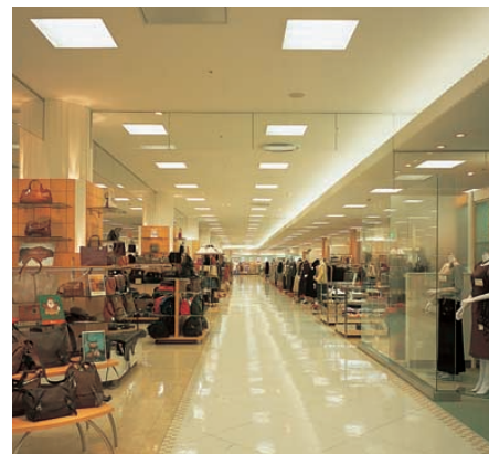
3階テナント(エクステリアゾーン) Tenant space on the 3rd floor (exterior zone) 下がり天井の建築内装を生かして間接照明を施し、柔らかな面光源によるグレード感と興行感を高めている
