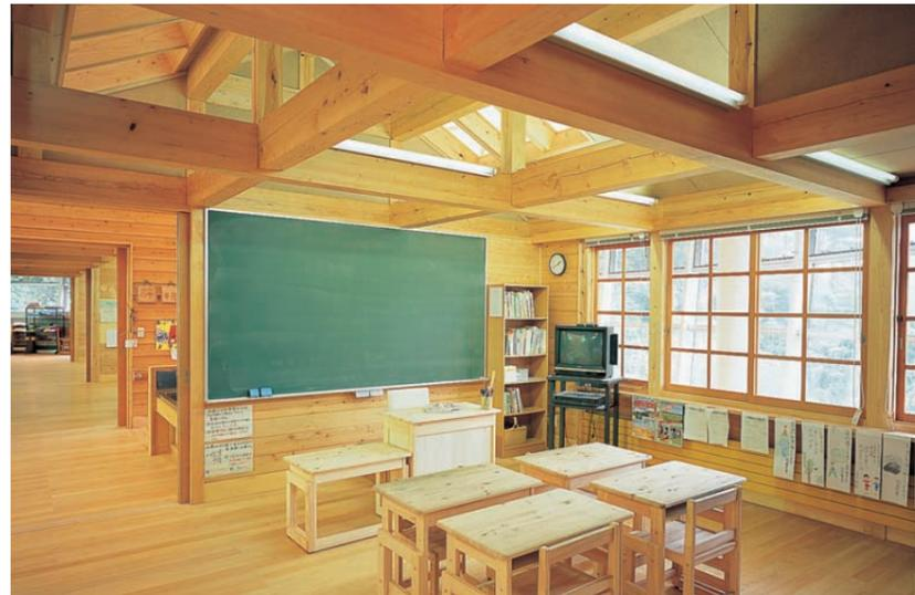
教室 木造の梁の部分にトラフ器具を使用し、天井部分にも光を与えて開放感を出している
