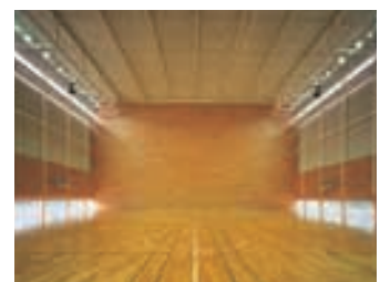
メインアリーナ Main arena 700Wメタルハライドランプ投光器を両サイド上部に設置
