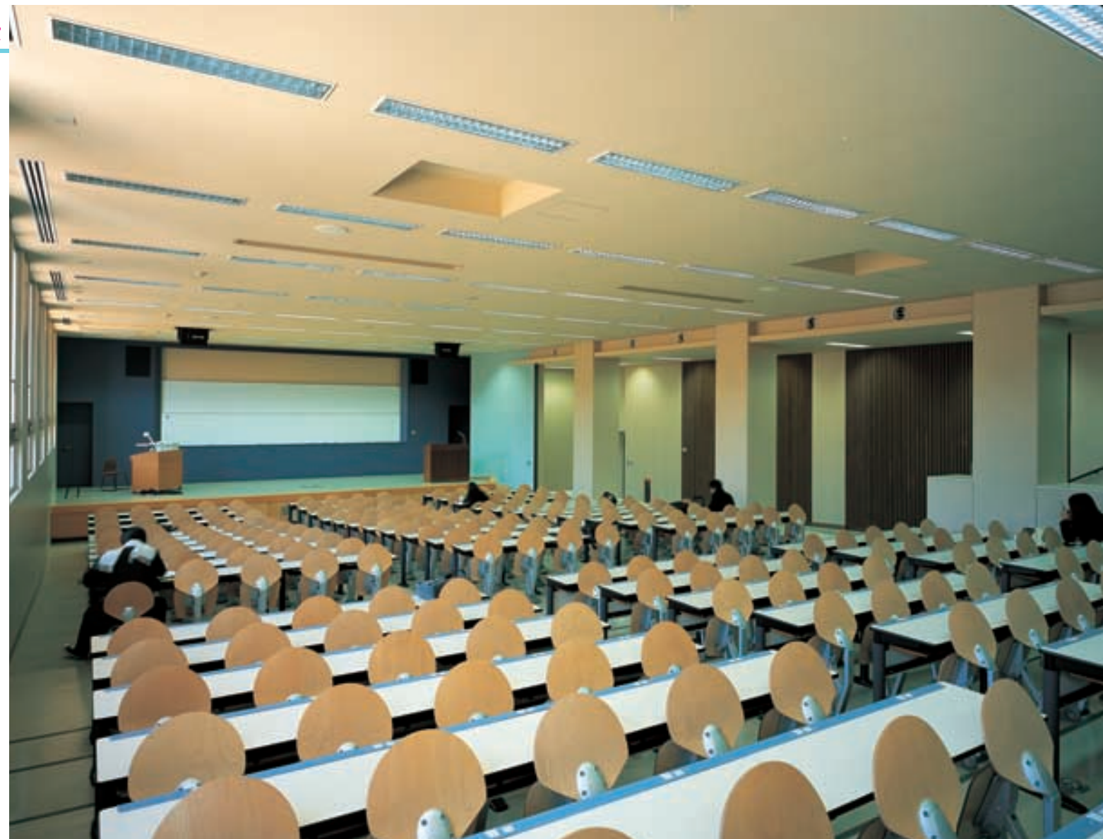
1階にあるマルチメディアホール Hf32W1灯用調光形埋込器具を採用。映像など多様な教育に対応できるような調光制御を可能にしている Multi-media hall on the 1st floor
