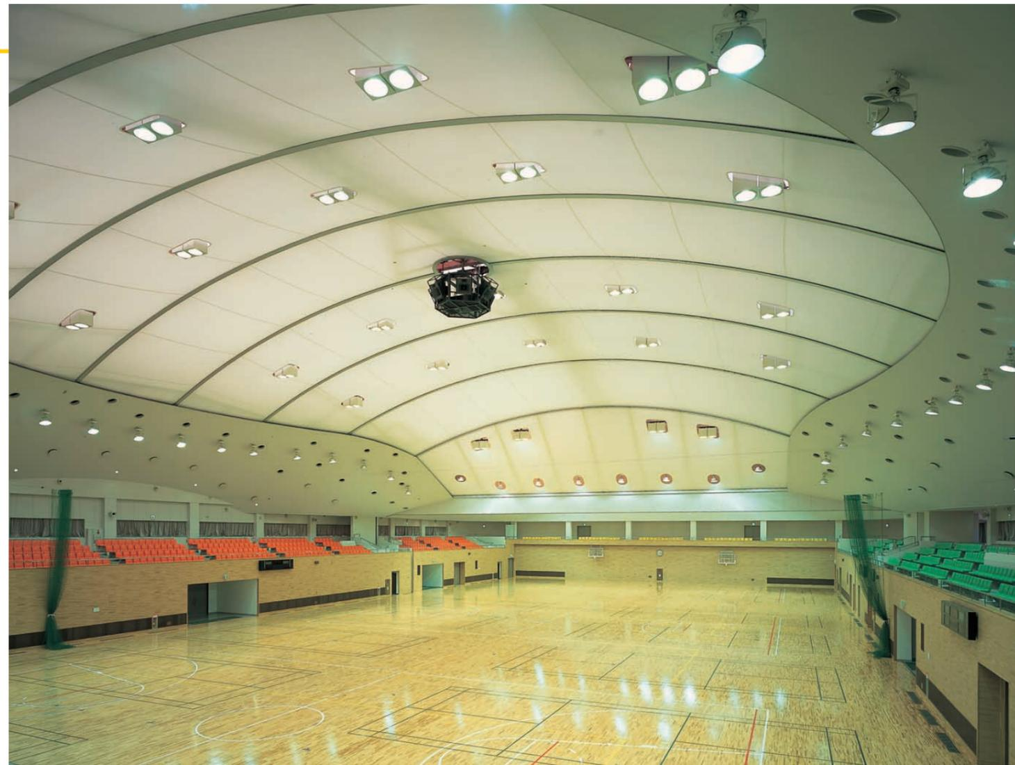
メインアリーナからサブアリーナ方向を望む(全点灯時):バンクライトは透過膜へ埋め込んですっきりした天井面とし、サイドライトは異形配光としてグレアを制御しながら鉛直面照度を確保
