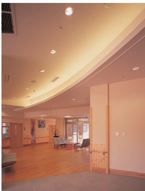
建築化照明と32Wユーライン3ダウンライト（電球色）により、温かみとグレード感を出した玄関ホール
