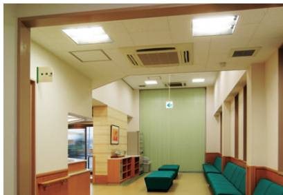
エントランスホール：Hf32W4灯用埋込器具（バツフル付）を配置。天井高さをとり、開放感を演出
