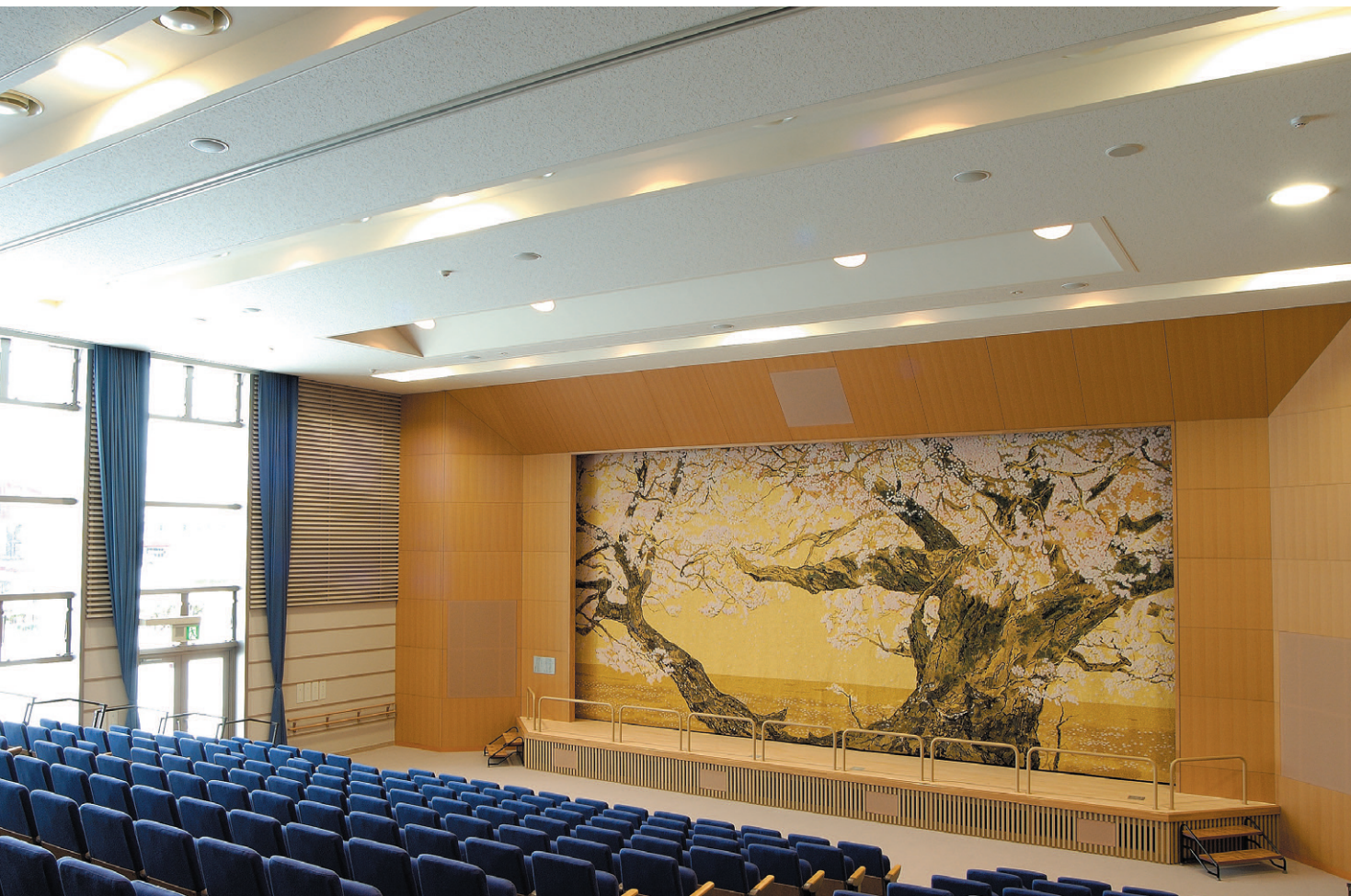
多目的ホール：400W HID埋込ダウンライトと250Wハロゲンランプダウンライトを併用し、グレードの高い空間を創りあげている
