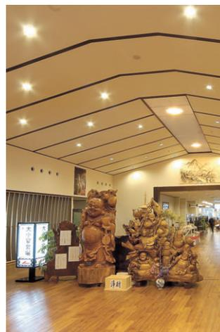
ロビー：高圧ナトリウムランプ埋込ダウンライトを設置し、照度400lxを確保
