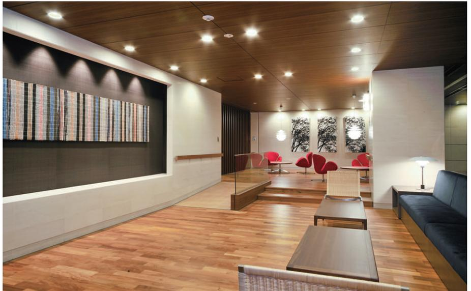
ラウンジの照明 ベース照明にランプ交換可能形LEDダウンライト、間接照明に演色性重視タイプのLEDダウンライトを採用
