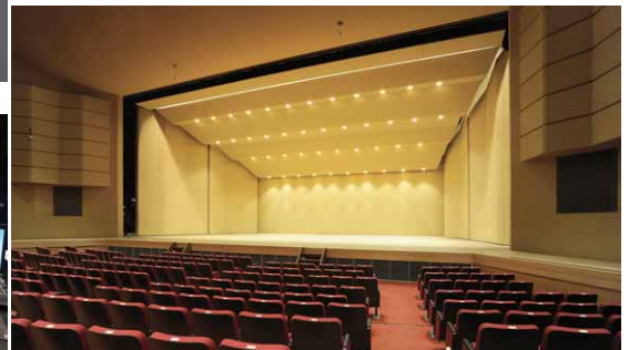
間口19m×奥行14m×高さ8mの舞台、天井反射板に44台のLED音響反射板ライトを設置
