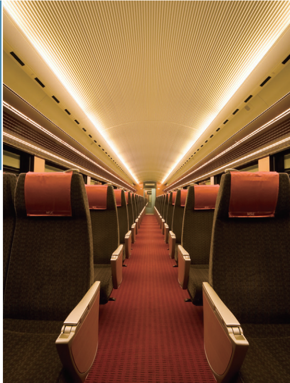
客室空間 高さ2.3mの天井面に蛍光灯の間接照明で広がりをもたせた客室内。荷棚下に電球色相当のLED照明ラインモジュールを配して上質な居住空間を演出している
