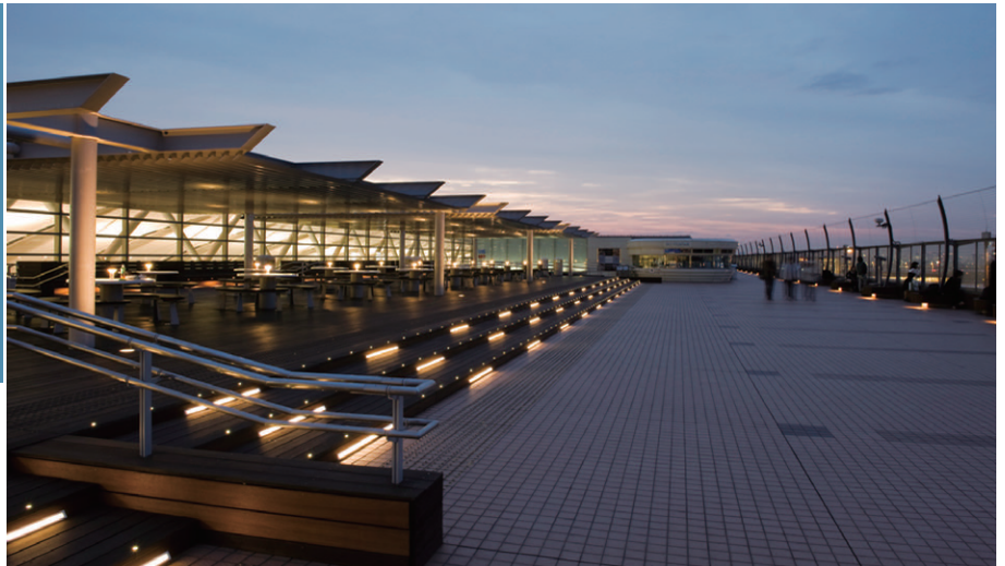
展望デッキ全景 ウッドデッキ階段の蹴上げの部分に、約3mピッチでLED屋外用ライン器具(特注仕様)が設置され、リズムカルな光感を創出して階段の段差を認識させる
