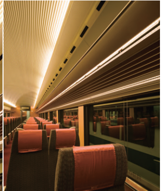
棚下のLED照明 棚下に埋込まれたLED器具は窓側の座席の明るさを補い、座席での快適な明るさを得る
