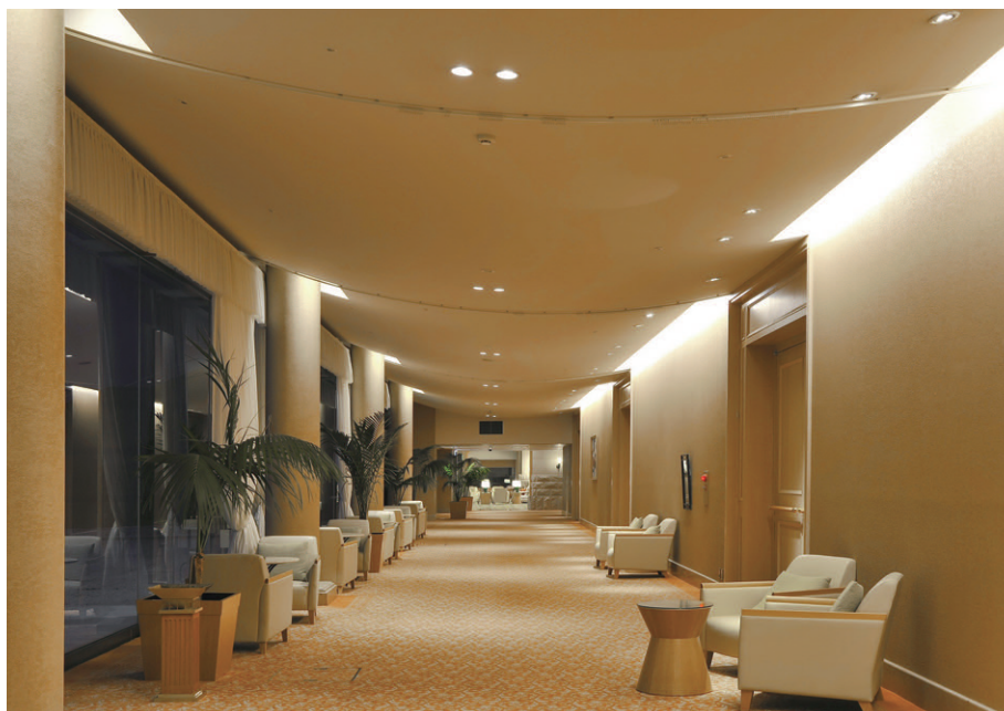
ウィンザーホールの大自然側に面したロビーの照明 高効率LEDダウンライト「E-CORE」を天井中央と壁側に配置し、十分な明るさを確保しつつ環境に配慮
