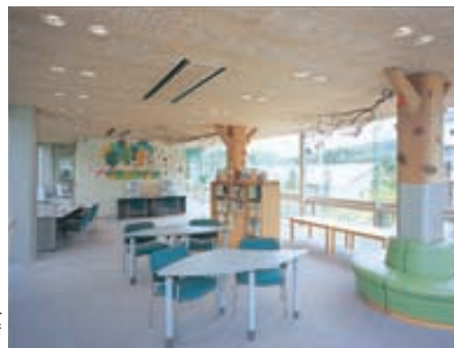
「情報コーナー」 ハロゲンランプ埋込ダウンライトのみでベース照明を行っており、落ちつきのある空間が演出されている
