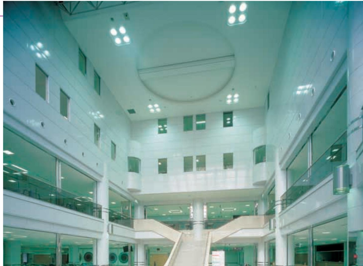
エントランスホール 4階吹抜け構造で天井には400Wメタルハライドランプ4灯用バンクライトを設置。聡明感を与える視環境をつくり出している
