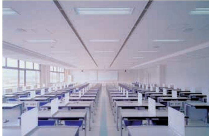
2階 学科試験室 40W蛍光灯2灯用埋込器具「ソフトライトM」80台を整列配置
