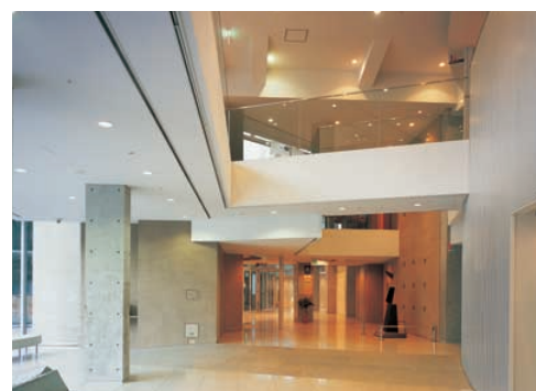
中央ロビー：27Wコンパクト形蛍光灯(電球形)を中心に配置 Central lobby
