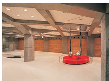
地下ラウンジ：HQIランプとハロゲンランプの混光照明をベースとし、壁面にはウォールウォッシャを配置 Lounge in the basement
