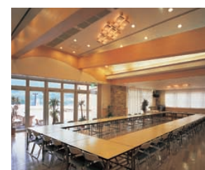
軽食コーナー：ベース照明に27Wユーライン2ダウンライト。和風の雰囲気のできる直付器具を配置 Snack corner
