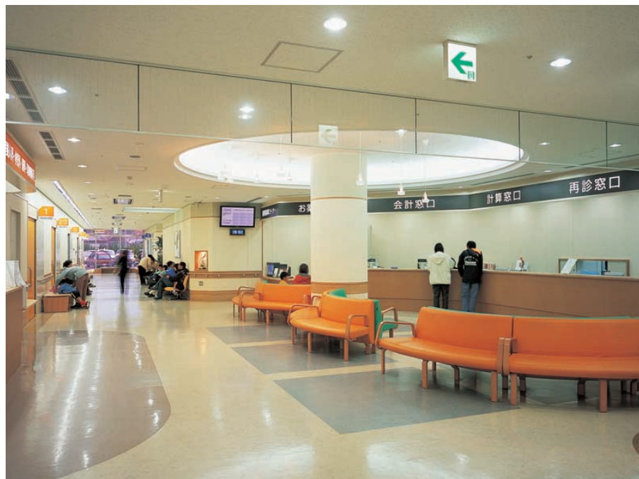
外来ロビーの照明：外来エリアの中心部として、柱を中央に円形状に意匠した天井からの間接照明と27Wコンパクト形蛍光ランプダウンライトにより、温かな雰囲気づくりと安心感を高めた空間演出をはかっている
