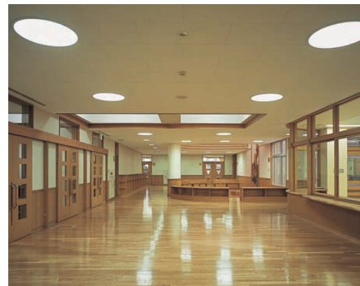
ホールの照明：アクリルカバーからの柔らかな光と昼光とが調和し、ホール全体に落ち着いた開放感のある照明効果が得られている
