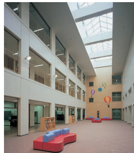
くぬぎホールの照明：トップライトから外光を採り入れ、補助照明に150W高演色形ナトリウムランプ投光器を採用
