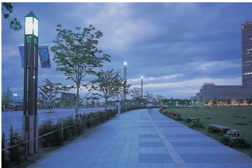
2本柱の照明ポールを採用し、灯具は「あんどん」をモチーフにデザイン化。2色発光HIDランプで季節に応じた雰囲気演出
