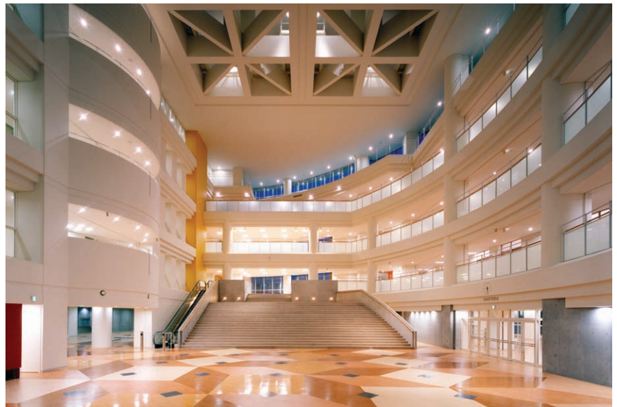
アトリウムホールの照明：間接的な照明で開放廊下の柱のシルエットを強調すると共に、アトリウム周辺に設置されたピンスポット照明により壁面を演出
