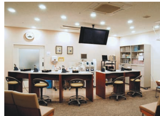
採血室の照明：昼白色のコンパクト形蛍光灯ランプダウンライトを採用
