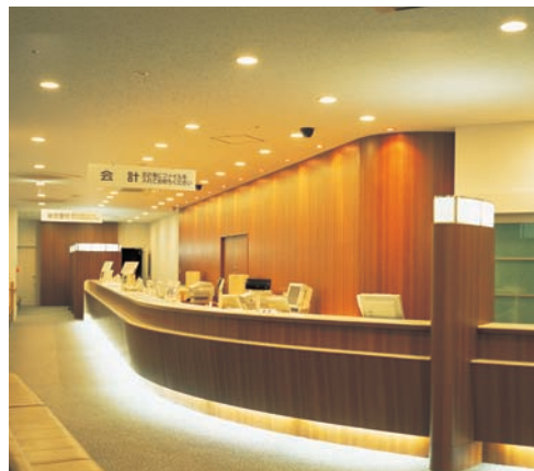
1階総合受付の照明：電球色のコンパクト形蛍光灯ランプダウンライトを整列配置し、不安感のない落ち着いた光環境を形成
