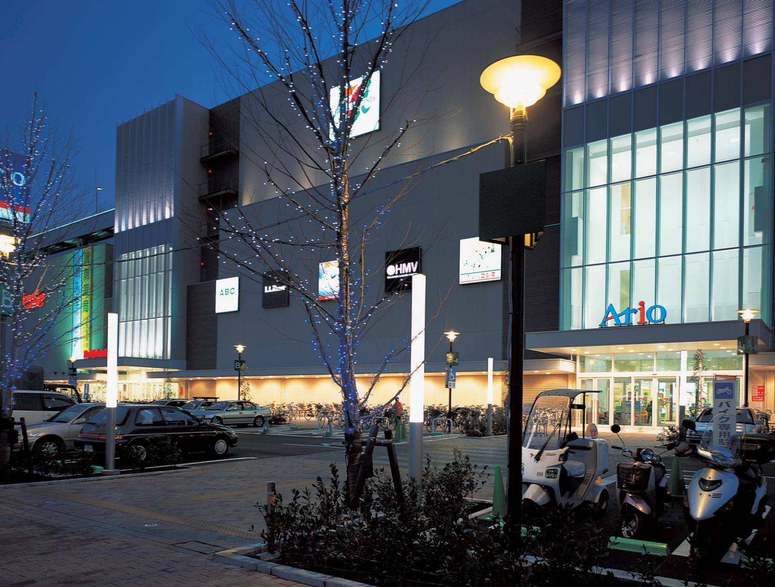
ライトアップされた外壁面上部：前面フロストフード付広角形投光器により、壁面に光ムラのないならかなグラデーション効果を創出
