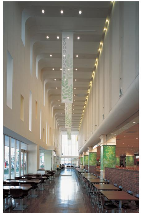
フードコート吹き抜けゾーンの照明：温白色(ネオセラ)のダウンライトを使用し、フードコート全体の調和を図っている
