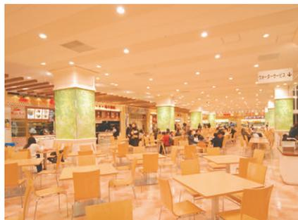
フードコートの照明：温白色の100Wセラミックメタルハイドランプ(ネオセラ)ダウンライトを設置
