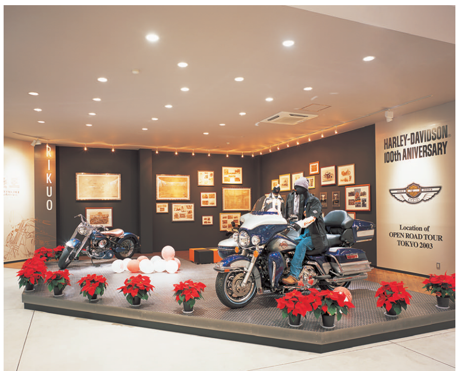
ヒストリーコーナーの照明：60Wハロゲンランプスポットライトをライティングレールで配置。ステージには35Wユニバーサルダウンライトでフレキシブルに演出
