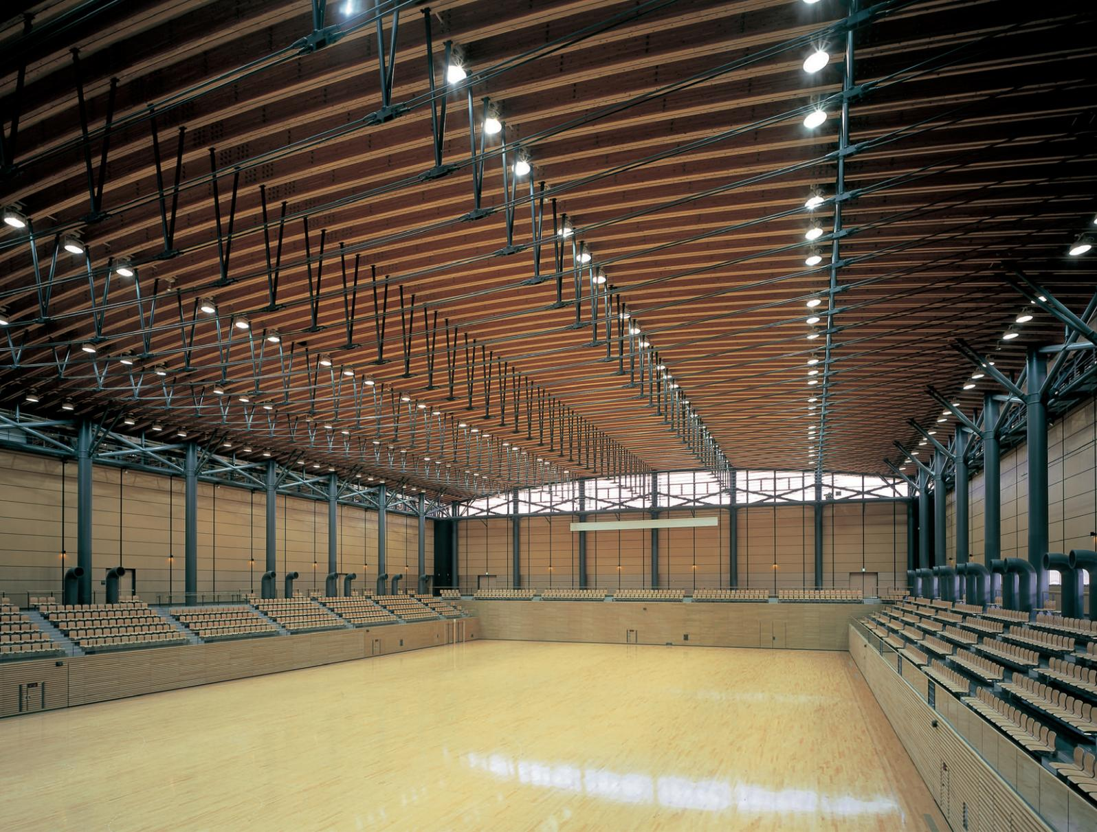
2階端からメインアリーナ正面を望む：サイドライティング器具はアリーナ長手方向両サイドから中央方向に斜め照射し、ボールを見やすくしている(左右端列の器具はTV撮影時に点灯)
