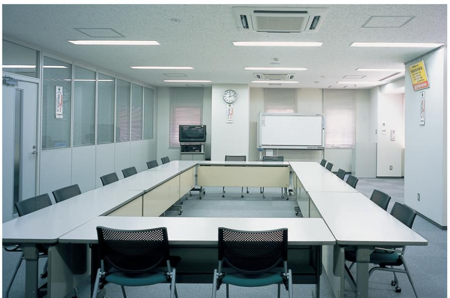
会議室の照明:32WHf蛍光ランプ2灯用埋込器具を採用し、ワイヤレスリモコンスイッチで調光制御
