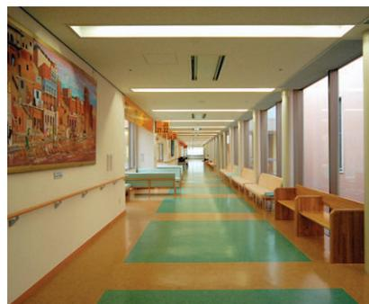
外来診察外待合室兼廊下の照明：天井スリット内に蛍光灯トラフと深夜専用の蛍光灯ダウンライトを設置
