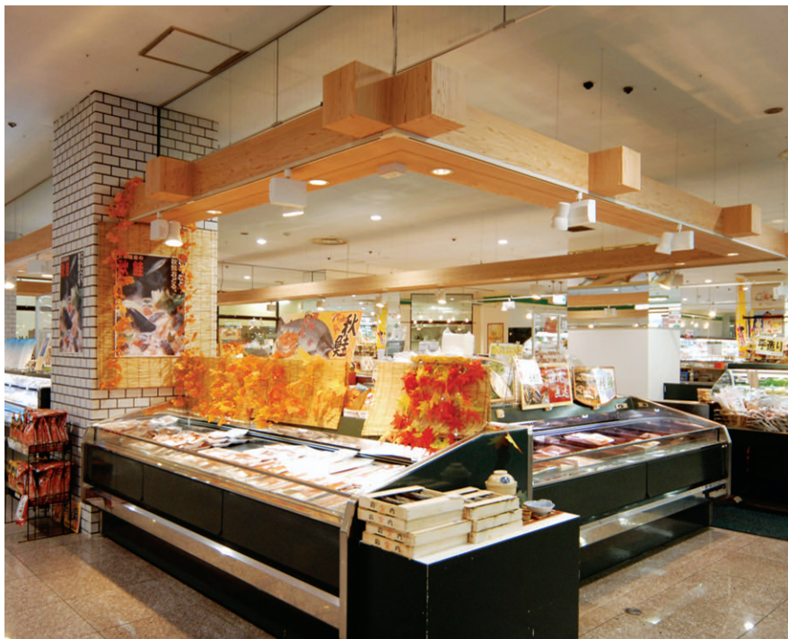
食品売場の照明：35W CDMスポットライトにより、商品の色をくっきりと鮮やかに見せるとともに、色焼けも防いでいる
