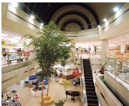
中央吹抜け部：400Wメタルハライドランプ投光器“プレアマルチ”を配置
