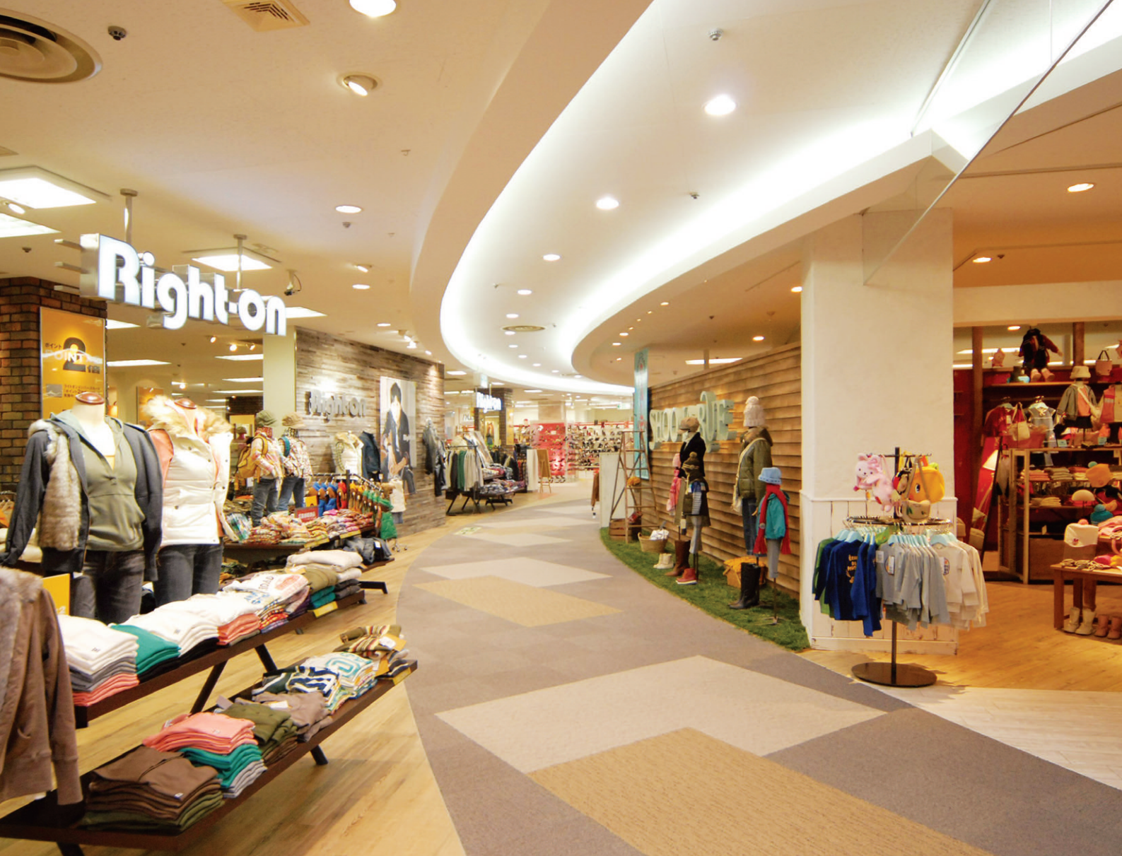
回遊通路の照明：トラフ器具を使用した建築化照明と100Wネオセラダウンライト“フロアマスター”を組合せることで、すっきりとした光環境を形成している
