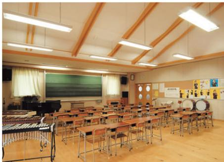
音楽教室の照明:スクールソフトワイヤ吊下器具を中心に、演出可能なダウンライト(FLD-18W)も設置
