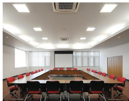
会議室の照明：3灯用埋込スクエア器具(バツフル付)と間接照明、下がり天井面に電球埋込ダウンライトを設置
