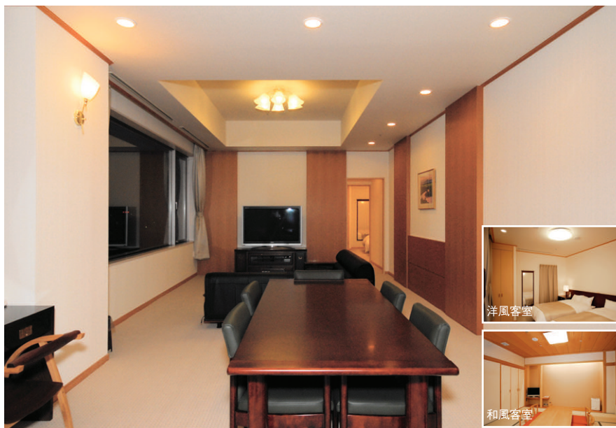
スイートルームの照明 居間の中央折り上げ天井内に白熱灯シャンデリアを設置し、人が集まる場所を強調。洋風客室、和風客室には住宅用シーリングライトを使用
