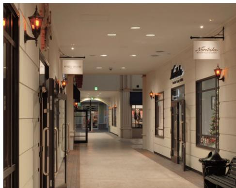
パサージュ感覚の屋内小路の照明 ダウンライト (ネオセラ200W形) を配置し、壁面にはガス灯をイメージしたセピア色のガラスのブラケット
