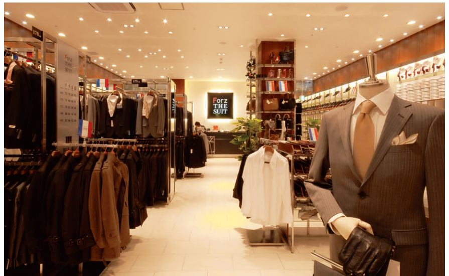
紳士服売場の照明 ローボルトハロゲンランプユニバーサルダウンライトを中心に重点照明。通路部はネオセラシステムダウンライトを配置
