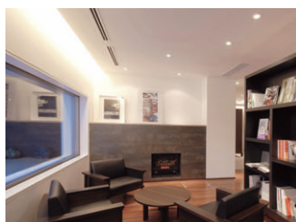
ラウンジの照明 ピクチャーウィンドの上部に間接照明を施し、景色が見渡せるように配慮
