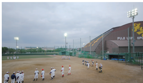
野球場の照明 投光器(M1.5kW)12台搭載のコンクリート照明柱(高さ19m)6基を採用
