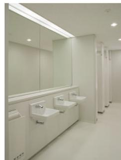
トイレタイルーム スリット状のカバーにHf32W1灯用を組込んだ建築化照明によって、人の表情を生き生きと表現する
