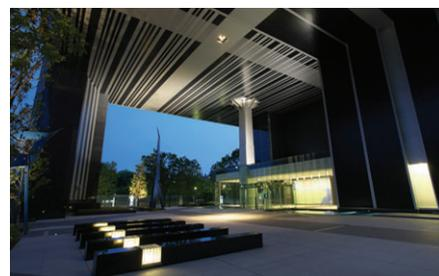
ピロティ ピロティの中央には電動昇降装置付ハロゲンランプ500W3灯1組のHID器具が人感センサと連動。柱の両脇とベンチの足元にセンサを備える
