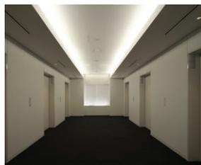
エレベータホール 基準階のエレベータホール。エレベータ上のトップライトとしてE-CORE40（電球色相当）を採用。中央部には間接照明を施す
