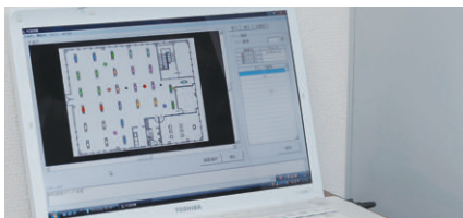
点滅エリアの変更や明るさの変更はパソコン画面で簡単に設定
