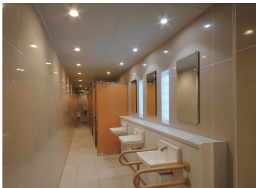
女子トイレ内 動線側にE-CORE60効率重視タイプ(電球色相当)を配し、鏡上には顔色を生き生きと表現するためE-CORE40演色重視タイプを配置している
