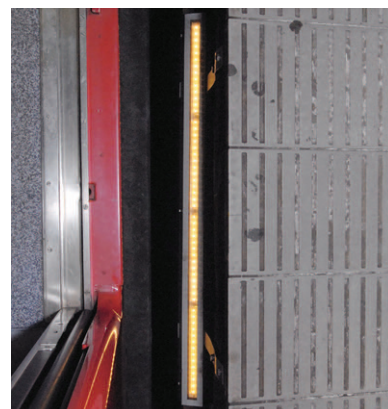
ドアとホームの隙間から望むLED足下灯
