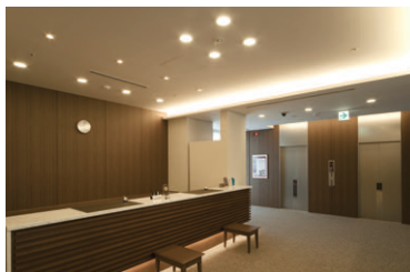
フロント 間接照明とFHT32W蛍光灯ダウンライトとの組合せでワンランク上の上質な佇まいを演出
