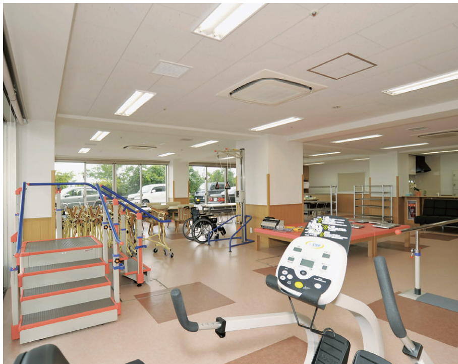
通所リハビリテーションの照明 FHF32W2灯用埋込器具を採用し、点灯区分を細分化して不要な明るさをカット
