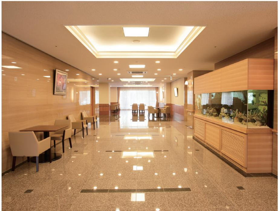
メインエントランスホールの照明 折上げ天井内の間接照明とその中央にカバー付スクエア器具を配置し、癒しの空間を形成
