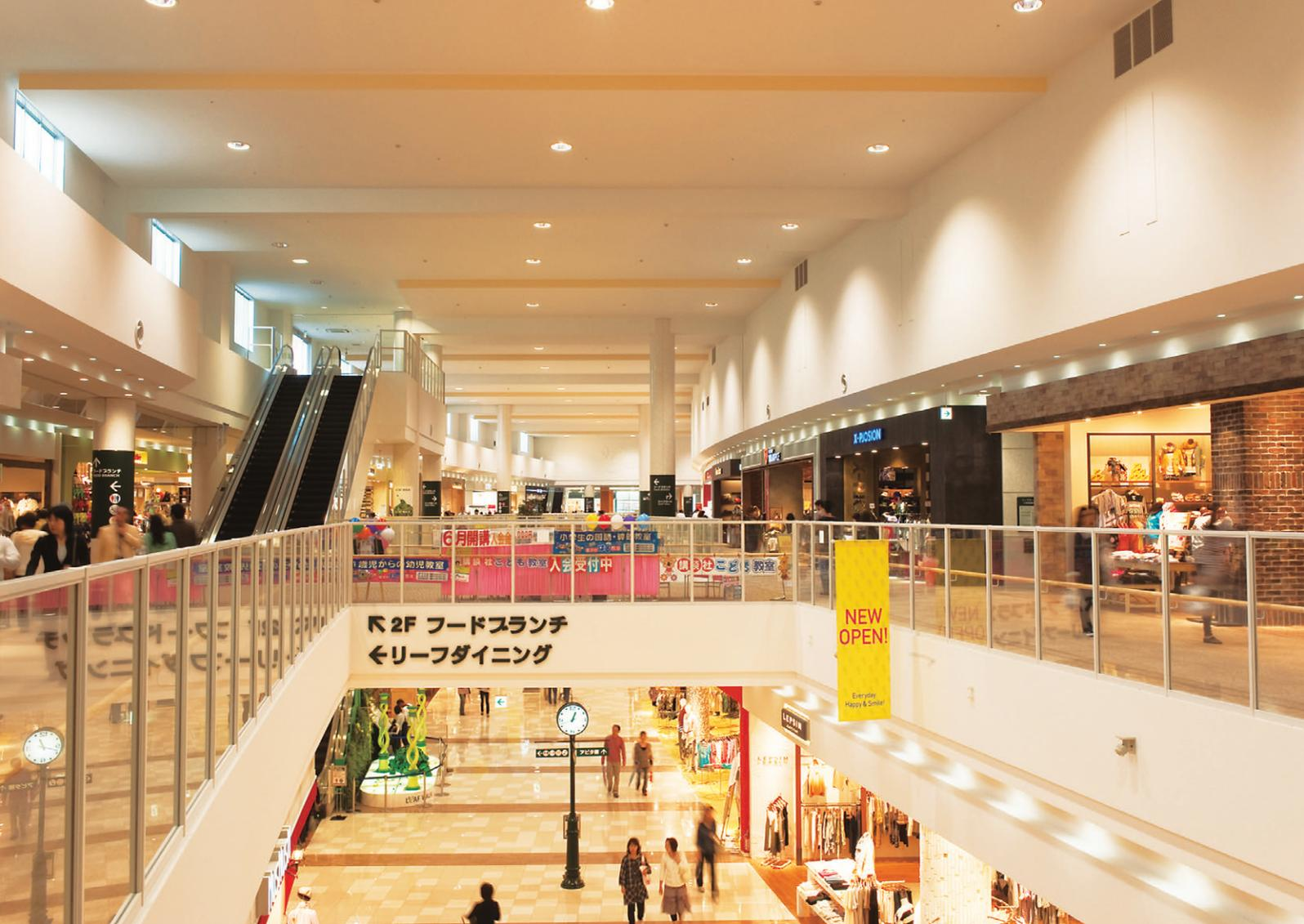
モール棟 モールの2階吹抜け天井には400Wネオセラダウンライトを中央に、その両側に250Wネオセラダウンライトを配置
