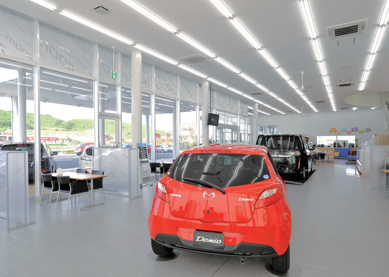
ショールーム奥側から受付方向を望む 外側から内部を見やすくするため高照度を確認しながら初期照度補正制御でランプ使用初期の余分な明るさをカット
