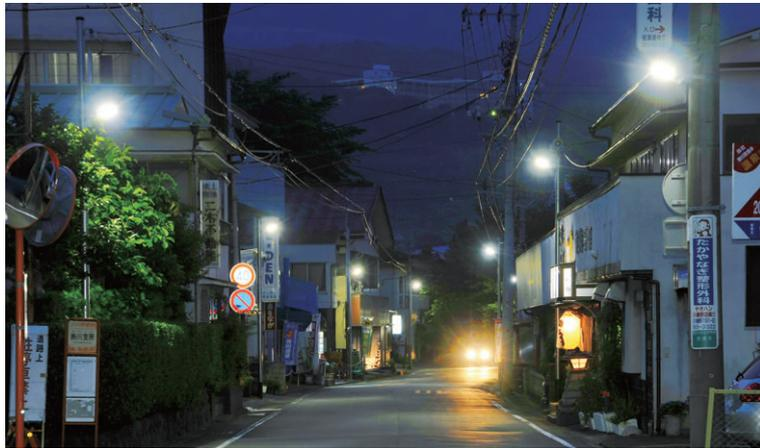
従来の100W水銀ランプ街路灯と同等の明るさで、消費電力、CO<sub>2</sub>排出量を約70%削減するLED防犯灯
